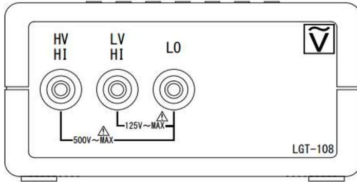
HVHI-LO端子間及び、LVHI-LO端子間に、測定プローブのバナナジャック(φ4)を接続して、測定を行います。
